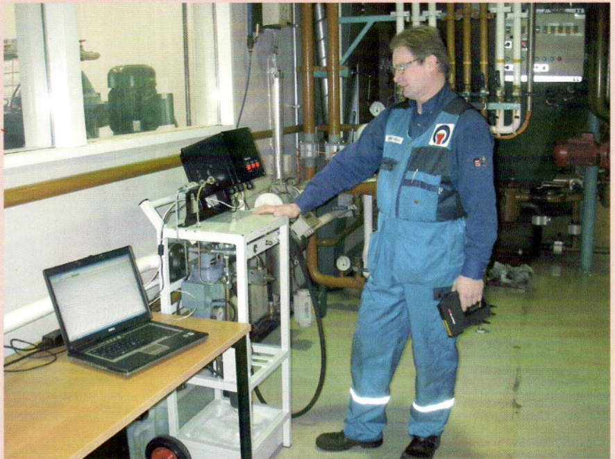
Kuva 3. Erkki Valli seuraa on line -hiukkaslaskimelta uusiööljyn puhdistusprosessia Ekokem Oy Ab:n tuotantolaitoksella Jämsänkoskella.
